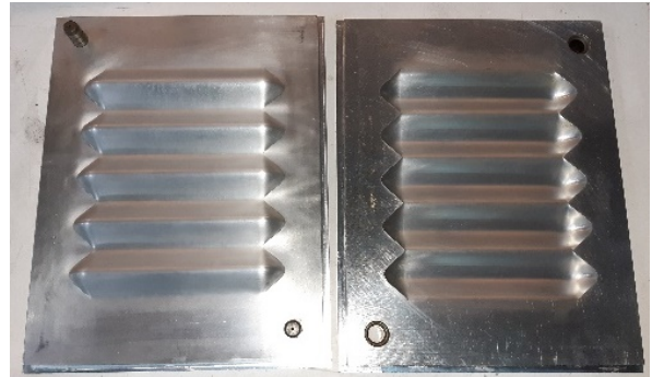
Figura 7. Molde de ondas fabricado en aluminio mecanizado.
