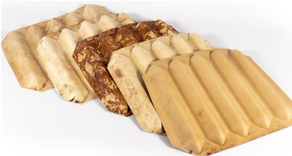
Figura 13. Prototipos obtenidos mediante termocompresión.
