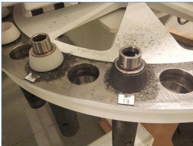
Figura 9: Residuos de CFRP producidos durante el mecanizado.
