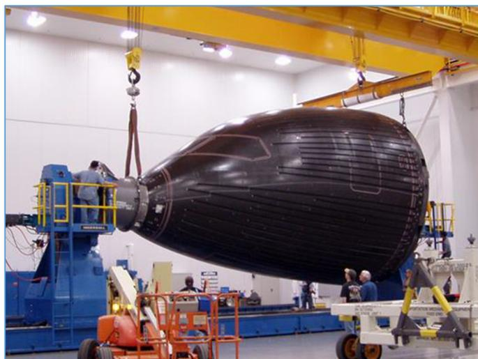
Figura 6: Útil de *“Fiber Placement”* y curado, fabricado en CFRP.
