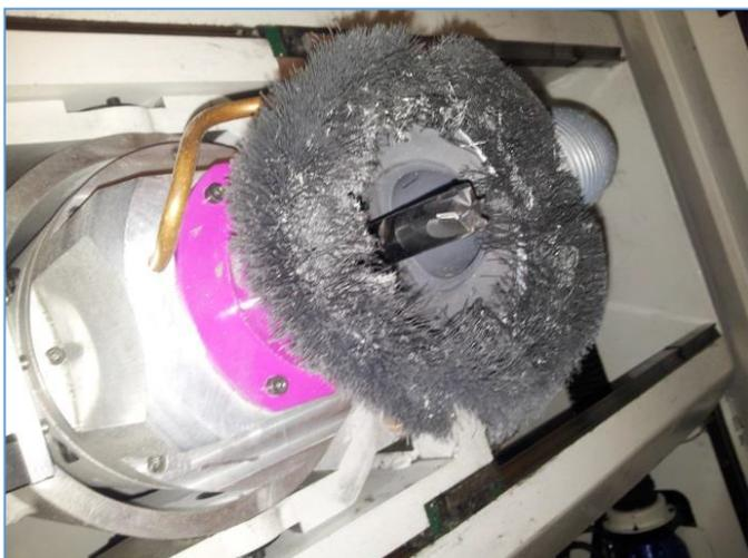
Figura 8: Cabezal de corte con herramienta PCD.
