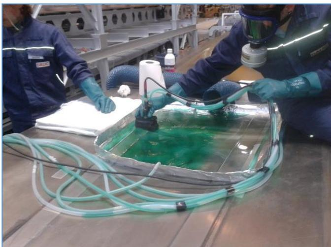
**Figura 10:** Reparación de cuna de INVAR36 mediante aporte de material por electrodeposición selectiva.
