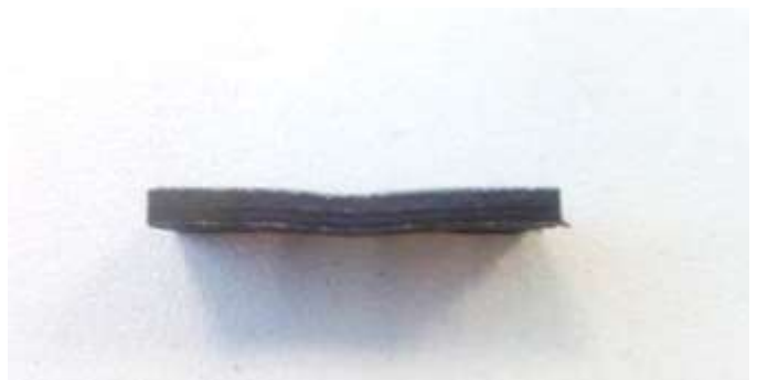
Figura 9. Probeta de fibra de carbono después del ensayo de cortadura interlaminar
