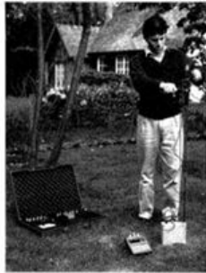
Pénétrmètre dynamique léger à énergie variable pour la reconnaissance des sols
