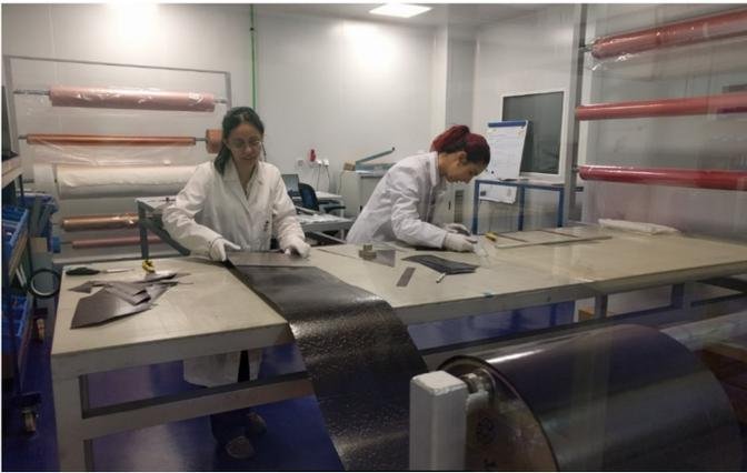
Figura 3. Operaciones de corte y laminación en sala limpia
