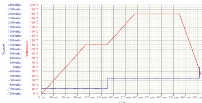
Figura 4. Ciclo de curado para monolíticos con prepreg OoA
