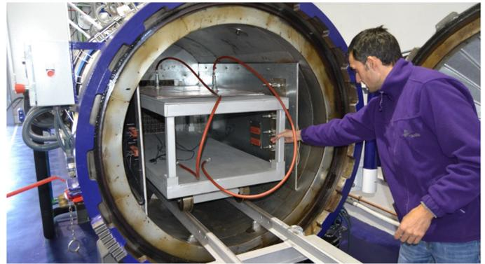
Figura 1. Curado de prepreg SM en autoclave
