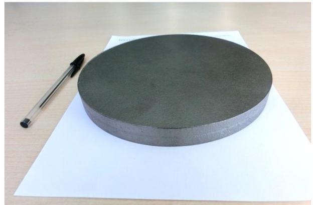
Figura 1. Pieza de 200 mm de diámetro obtenida mediante SPS
