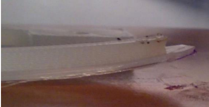
Figura 9. Efecto “warping” en una de las esquinas de las probetas de nailon para el ensayo G_{IC} impresas en dirección horizontal
