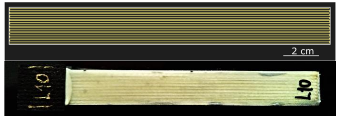
Figura 13. Probetas lisas de fibra de vidrio para el ensayo G_{IC} impresas en dirección horizontal
