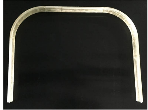
Figura 11. Vista general de un perfil curvo sin defectos fabricado con refuerzo en formato roving .
