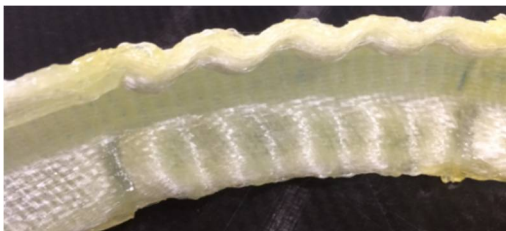
Figura 10. Detalle de las arrugas obtenidas en un perfil curvo fabricado con refuerzo en formato banda cuasi-unidireccional.
