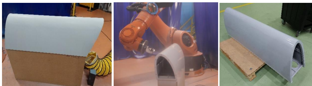
Figura 8. Imágenes del borde de ataque antes (izqda), durante (centro) y después (drcha) de la aplicación del recubrimiento antihielo.
