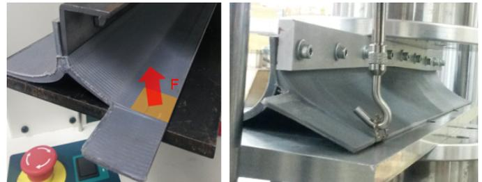
Figura 4. Ensayo para determinar la carga para levantar el sello
