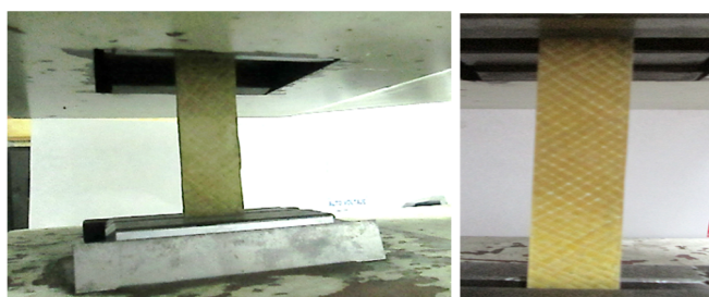
Figura 7. Montaje de las probetas de tracción.
