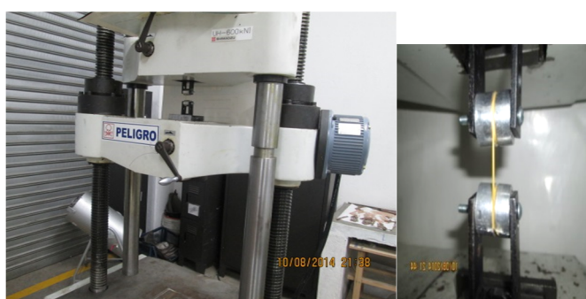
Figura 6. Máquina universal de ensayos y accesorio para fibras.
