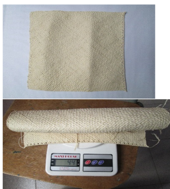
Figura 3. Tejido de refuerzo y peso de cada capa utilizada.
