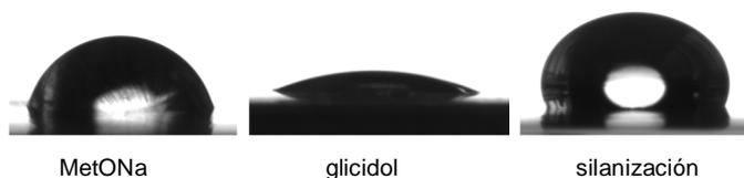
**Figura 7.** Angulos de contacto con el agua que presentan las superficies del aluminio (serie 8) tras cada uno de los tratamientos a los que se ha sometido.
