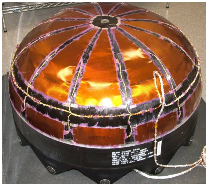
Figura 7. Tanque de xenón del sistema de propulsión de iones "Dawn", realizado mediante la técnica "overwrapping" con un revestimiento de titanio cubierto con grafito-epoxy (fuente: JPL NASA)
