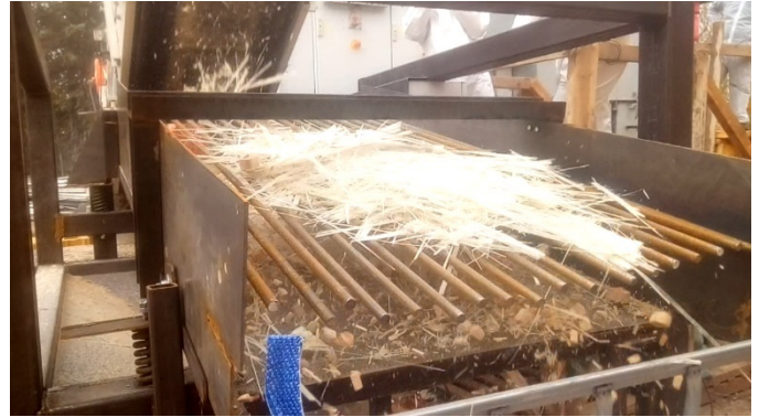
Figura 6. Mesa vibrante en uso en el reciclado de palas.
