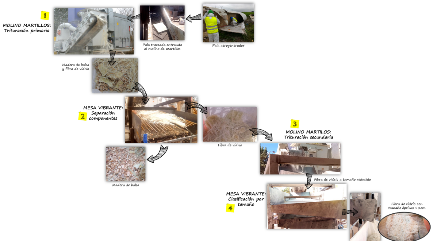
Figura 4. Proceso reciclado mecánico palas aerogenerador.
