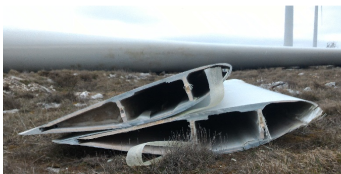
Figura 1. Sección de una pala de aerogenerador.
