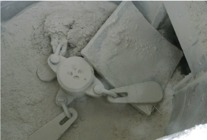
Figura 5. Martillos en uso en el reciclado de palas.
